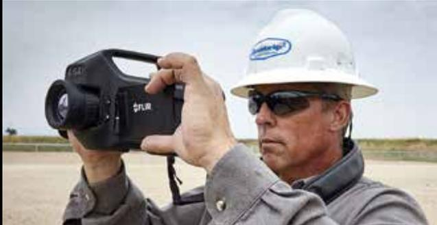
La detección óptica de gas le permite trabajar desde una zona segura y detectar indicios de penachos de gases peligrosos. A continuación, puede acercarse para completar la inspección. Inspeccione accesorios y conexiones difíciles de alcanzar sin arriesgarse a colocarse en zona de peligro. Cuando encuentre la ubicación exacta de una fuga, el trabajo de reparación podrá realizarse rápidamente.
